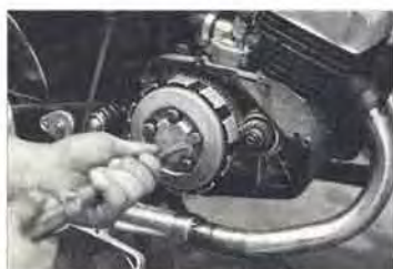
①クラッチスプリングホルダースクリューを取外せば……
