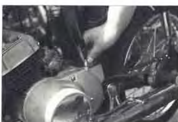
⑬ワイヤーの遊びが不適正な場合はワイヤーアジャスターで調整し……
