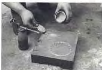
⑨クラッチ板に歪があるような場合は、光明丹を用いて見分けます。
