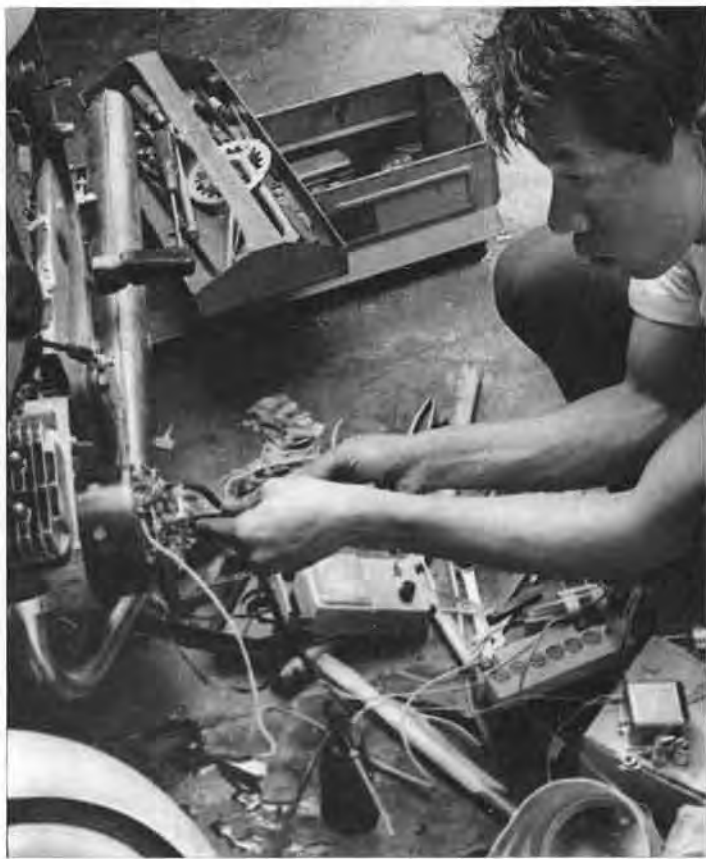
▲サービス指導を全般的に行なったため、シンガポールのディーラーのメカニックの人たちは、すばやく正しいイグニッション・タイミングの合わせ方を完全に理解してくれました。もちろん、ポイントチェッカーとダイヤルゲージでタイミングを合わせるわけですが、とにかく、すべてのメカニックが、写真のような完備されたツールを一箱ずつもっているのには感心しました。
