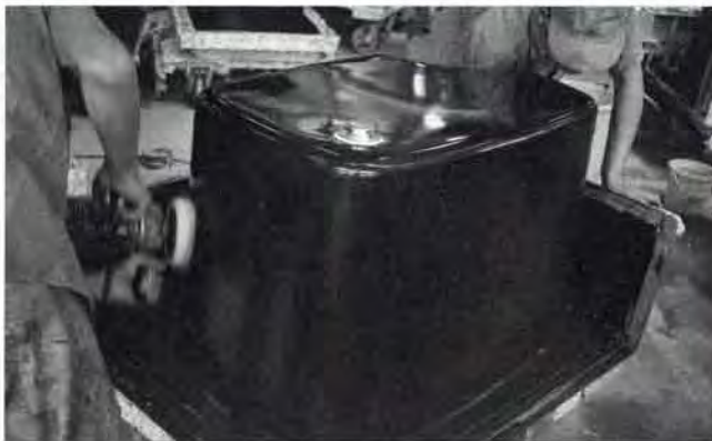
ボートとは反対に雄型が使われる 肌ざわりをよくするため慎重なバフ掛けをする
