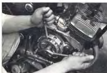
⑤クラッチ回り止めの専用工具を使って、クラッチポスのロックナットを外せば……
