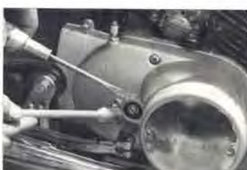
⑭クラッチの作動調整はスクリューナットで調整します。
