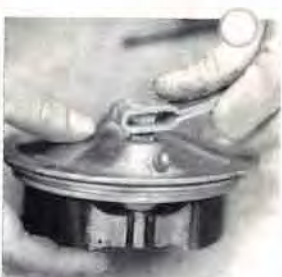
⑭あらかじめカムレバーの噛合を1コマないし2コマぐらいずらしておくか……
