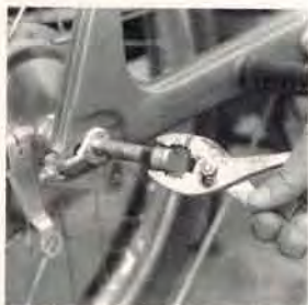
⑤次に車軸を止めているナットを外して車軸を引抜けば……
