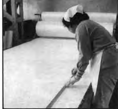
ボートの強さを増すガラス繊維のマットが型紙に合わせて裁断されていきます。
