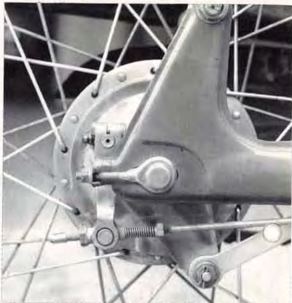
①ブレーキライニングが調整の範囲を越えて摩滅してくるとカムレバーの位置がたつてくる。もちろんこの前の段階でライニング・シューの交換をすすめなければなりません。
