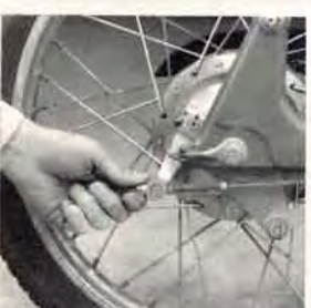
⑮そのまま車体に組つけてからカムレバーの位置を調整し
