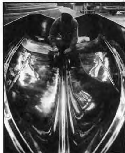
グランドピアノのようにきれいなボートの雌型に離型剤を塗りつけます
