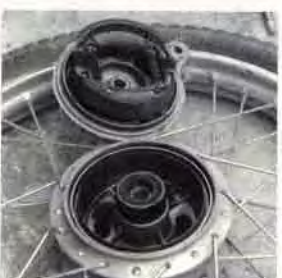
⑦そこでシュープレートをとり……
