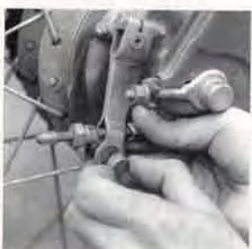
④ロッド（またはワイヤー）からクレビスピンを抜きます
