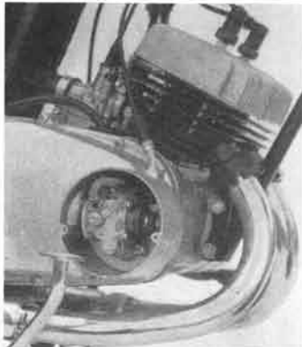
2気筒、2キャブ、オートループのツイン90、のたくましいエンジン
