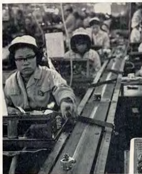
ベルトコンベア・システムで手際よく組立てられていくオートループ 加工精度に増して組立精度は万全を期しておりテストは厳重をきわめている
