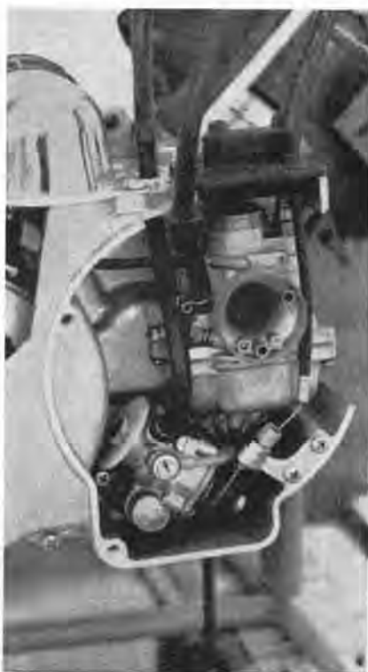
YA6のオートループ装置
