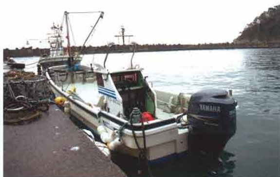
27~30尺の和船に100~150馬力の船外機を搭載したモデルが養殖運搬船のスタンダード。このクラスはまだ2ストモデルも多く、4ストへの移行途中だという
