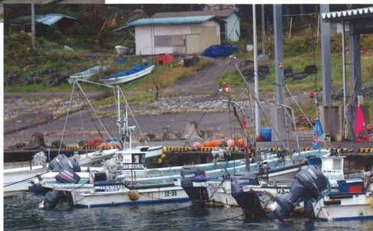
運搬船で使われる100馬力クラスの船外機から4ストローク化が進んでいる
