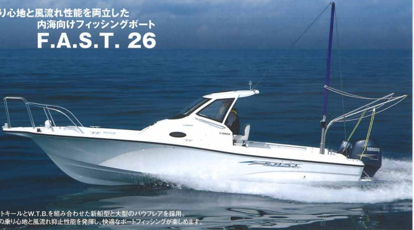
フラットキールとW.T.B.を組み合わせた新船型と大型のパウフレアを採用。
