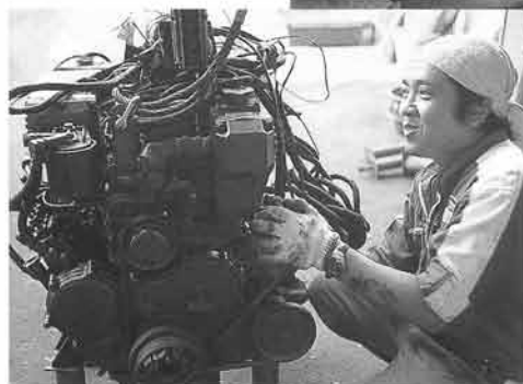
前日の台風23号の被害で完全に水没したエンジンをレストアするサービスの井上さん。「今年是这样い仕事が多いですね」と苦笑い。
