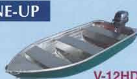
V-12HD 底板を厚く強化し、ボート全体の強度を高めたヘビーデューティモデル
