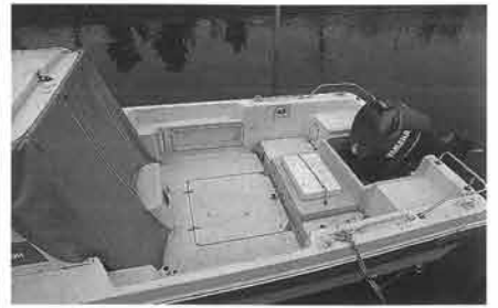
プレジャーユーザーの換装も積極的に対応している。写真はF-22のS/DをHPDIに換装した例
