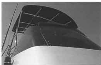
後傾とすることで風防効果を高めた。SF-31のように垂直に立つウィンドシールドは必要ない
