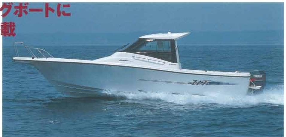
〈主要諸元 (Z200N船外機パッケージモデル)〉 ■全長：8.61m ■全幅：2.70m ■全深さ：1.38m
