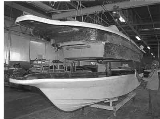
型の作成からゲルコートの吹き付け、FRPの積層、成型、完成後の検査まで高度なスキルが要求される
