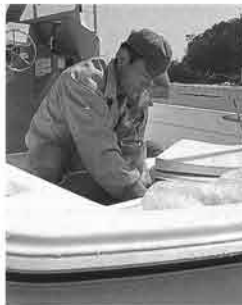
型の作成からゲルコートの吹き付け、FRPの積層、成型、完成後の検査まで高度なスキルが要求される
