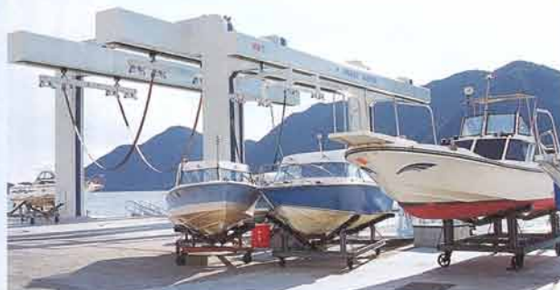
昨年7月に完成したばかりの主機25トン・補機2.8トンの上下架用のクレーンは、このマリーナの新たな顔である
