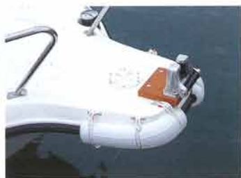
パウには三方ローラーをセッティング
