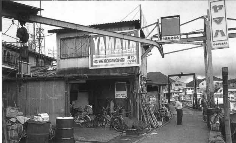
静谷川の脇に建つ工場。上のレールは船から揚げたエンジンをそのまま工場内に運ぶためのもの
