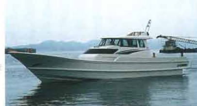
[主要諸元] ●全長：13.9m ●全幅：3.2m ●全深：1.52m ●総トン数：6.6t ●適合エンジン： MD630KUH又はMD980KUH ●最高出力：380ps/550ps ●定員14名 (船員含む) ●航行区域：限定沿海
