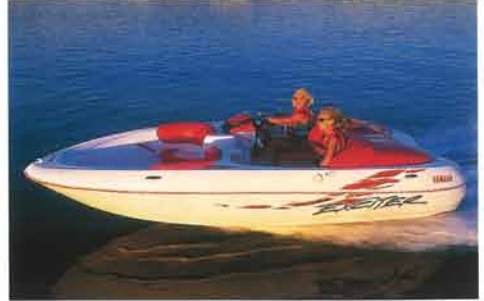
EXCITER1670T/S ( ) 内は1670S ●全長：5.05m ●全幅：2.32m ●定員：5名 ●搭載エンジン：122ps×2基 (122ps×1) ●航行区域：限定沿海
