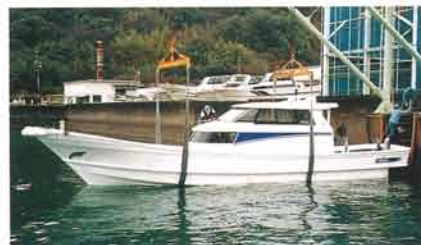
[主要諸元] ●全長：13.9m ●全幅：3.2m ●全深：1.52m ●総トン数：6.6t ●適合エンジン： MD630KUH又はMD980KUH ●最高出力：380ps/550ps ●定員14名 (船員含む) ●航行区域：限定沿海
