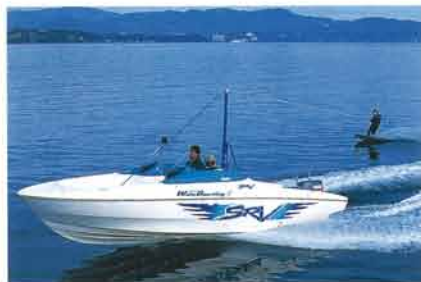
[主要諸元] ●全長：6.43m ●全幅：2.00m ●全深さ：1.05m ●総トン数：5トン未満 ●完成重量：722kg ●燃料タンク：75ℓ ●最大搭載馬力：70ps ●搭載エンジン：70BETOL付 ●定員：6名 ●航行区域：限定沿海
