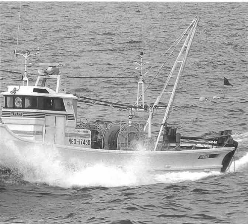
新潟で板曳き用の漁船として注目されるDX-51。写真は「明豊丸」。ドラムを設置するためOB仕様のブリッジを約1m前方に移動させた工場特装となっている
