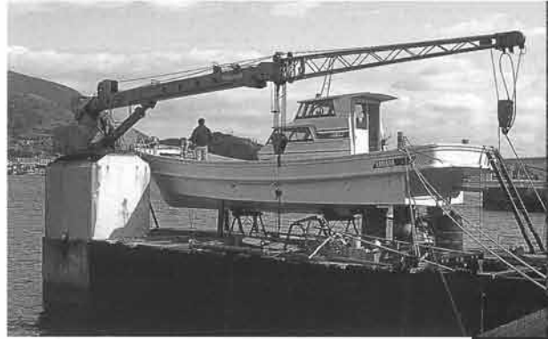
店舗前の揚降施設ではDX-39が機装中だった。自作のクレーンは廃車と廃船を利用した
