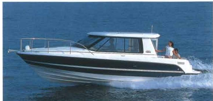
〈主要諸元〉 ●全長:8.68m ●全幅:3.05m ●総トン数:5トン未満 ●完成重量:2885(2285)kg
