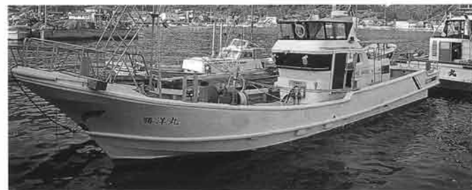
広沢さんのハマチ作業船・DX-60。大量のエサと、それを送り出す機装が積まれるため、船には十分な安定感、エンジンには強力なパワーが要求される
