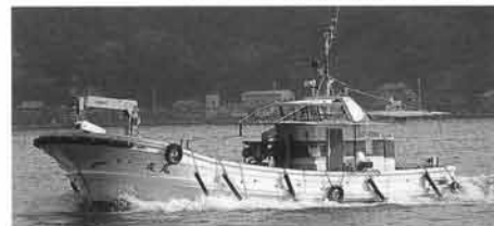
広沢さんのハマチ作業船・DX-60。大量のエサと、それを送り出す機装が積まれるため、船には十分な安定感、エンジンには強力なパワーが要求される
