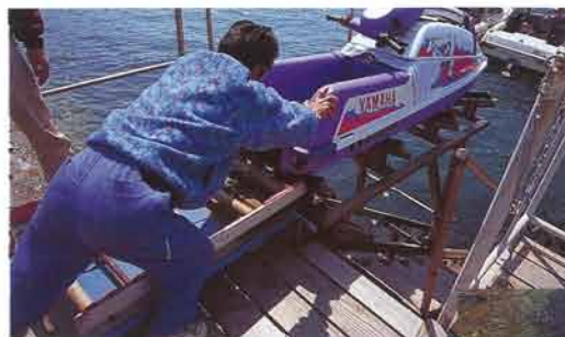
同社オリジナルのマリンジェット専用揚降施設。高い岸壁から貨車に船台ごとジェットを載せ、ケーブルカーが山を下るようにして海に降ろしている
