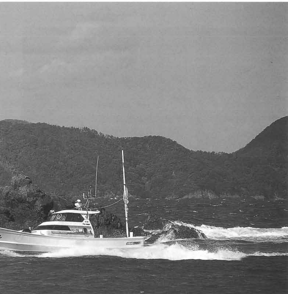
一昨年、進水した八木さんの新艇「明潮丸」(DY-48H-0A)。日本海の荒波に負けないよう、600馬力のMD-1250KUHを搭載(船体は出鱈仕様とし、総トン数6.0トンに変更)。父親の録朗さんとともに2隻を駆使して毎日漁に出る
