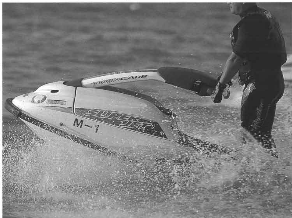
ツインキャブの搭載、ポール可動位置の変更などによりさらに乗りやすくなったMJ-700SJ
