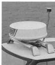
(マストゲート2本組+レーダーベース+マスト)をセットした状態
