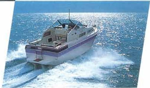
主要諸元 ●全長…7.55m ●全幅…2.84m ●全深さ…1.64m ●船体重量…1,920kg ●呼称最大馬力…260×1(145×2)PS ●連続最大馬力…230PS ●定員…10名 ●燃料タンク容量…270ℓ ●航行区域…沿海
