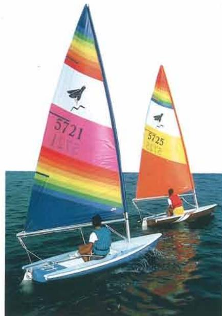
主要諸元 ●全長…3.43m ●水線長…3.16m ●全幅…1.32m ●吃水C・B up…0.10m、down…0.75m ●艇体重量…45kg ●完成重量…59kg ●全セイル面積…5.7㎡
