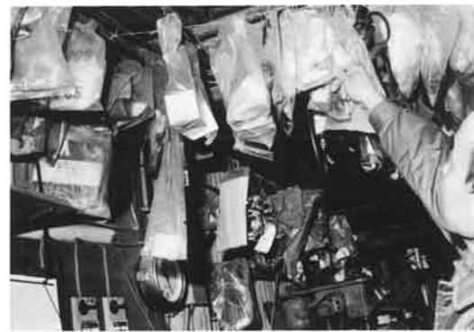
部品は種類別に分け、透明ビニール袋に入れて吊下げてあるから、在庫数量がひと眼でわかる。
