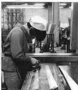
マンドレルに樹脂をしませたクロスをアイロンでつける
