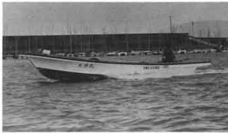
ノリ養殖にはヤマハ和船W-30、W-32(船外機55馬力)が、貝採り船にW-25(船外機25~55馬力)が現在の主力商品となっています。
