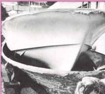
⑥雌型をはずすとすでに塗装されたボートが表われます。
