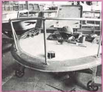
⑦デッキがつけられ機装され次第にボートらしくなります。
