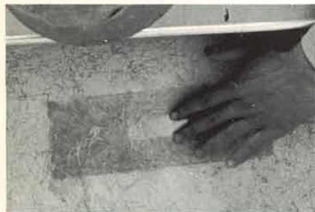
ボートの内側に空気が入らないように指でのばしながら2-3枚貼りつけます 硬化剤は夏0.5%冬2%位入れます この硬化剤は過酸化剤ですから火気に注意してください
