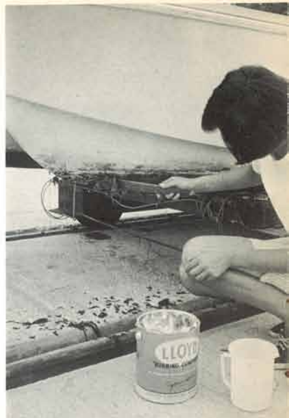
ボートを痛めないように木片のスクレーパーを使ってください
