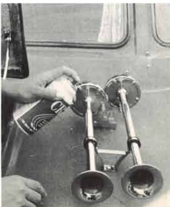
きれいな布でふきあげたあとCRCを充分にふきつけてください
