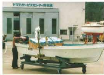
各種計測機器の搭載と浜名湖での走行テストも完了し調査本船への積み込みを待つ無線操縦艇
