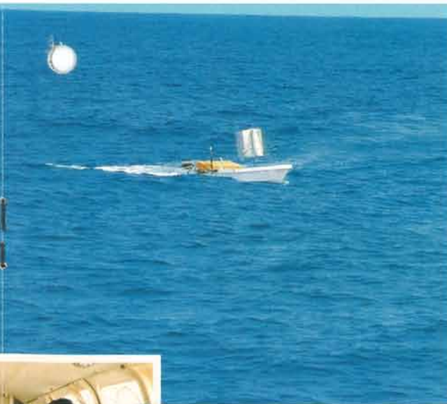
各種計測機器の搭載と浜名湖での走行テストも完了し調査本船への積み込みを待つ無線操縦艇
