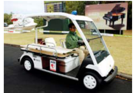
AED（自動体外式除細動機）や担架などを装備した「ヤマハゴルフカーアンビランスタイプ」
