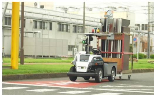
工場建屋間(屋外)にて部品を自動搬送する「eve auto」
