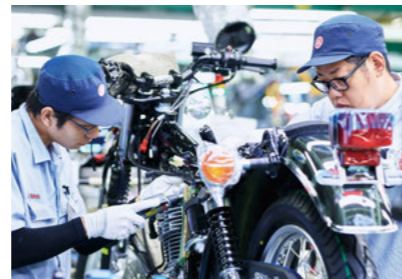
ロングセラーの「SR400」は二人組の「セル生産」で全行程を組み上げる。
