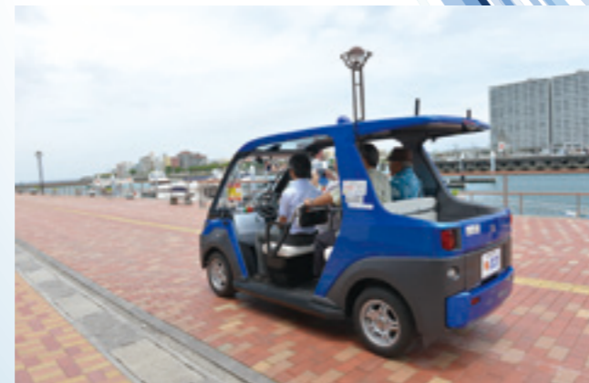
ランドカーベースの低速自動運転システム
