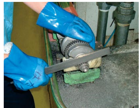
図3 ヤスリがけ(手作業)
