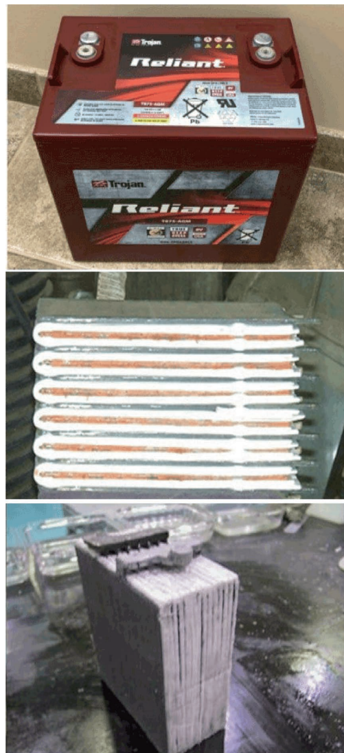
図2 AGM バッテリー構造
