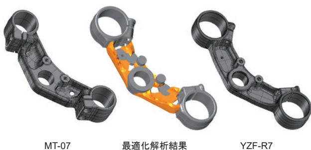
MT-07 最適化解析結果 YZF-R7 図2 アンダーブラケット形状の最適化解析
