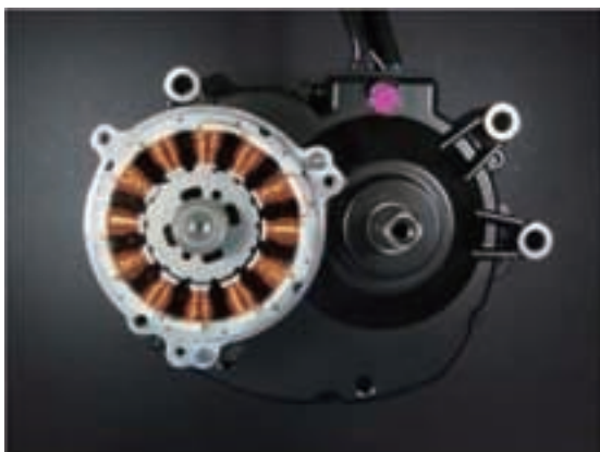
図12 12スロット14ポールのモータ部
