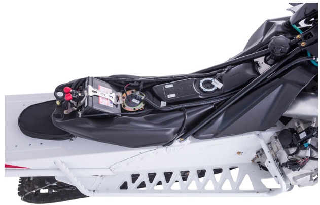
図12 フューエルタンク
