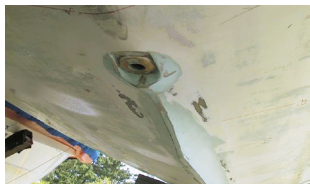
図 7 貫通ピースのリセス形状（プリ評価での造り込み写真）
