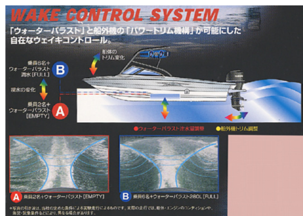
図3 ウエイキコントロールシステム概念図
