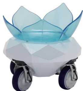
図10 8軸制御コンセプトモビリティ「Natchey」
