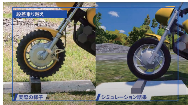
図7 段差乗り越しシミュレーション 実機との比較
