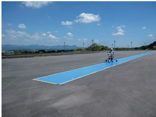
図2 実機による \mu-\lambda 特性計測試験
