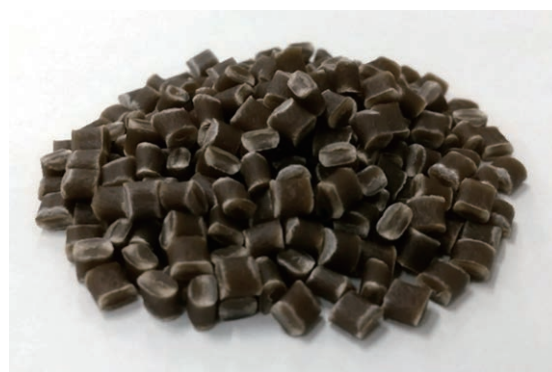
図1 セルロースナノファイバー強化樹脂 「Cellenpia Plas®（セレンピアプラス）」
