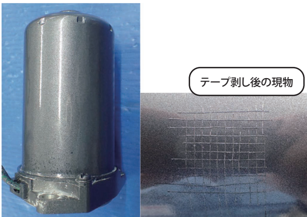
図9 評価終了時状態(左:耐食性、右:密着性)
