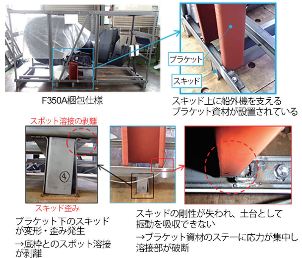
図4 振動試験による資材破損の起点箇所
