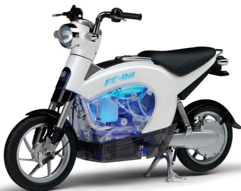
図4 DMFC搭載二輪車 (FC-Dii)
