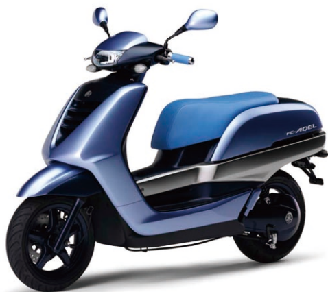
図7 PEFC搭載2輪車 (FC-AQEL)
