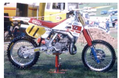
図2 モノクロスサス・アルミフレームを採用したYZM500
