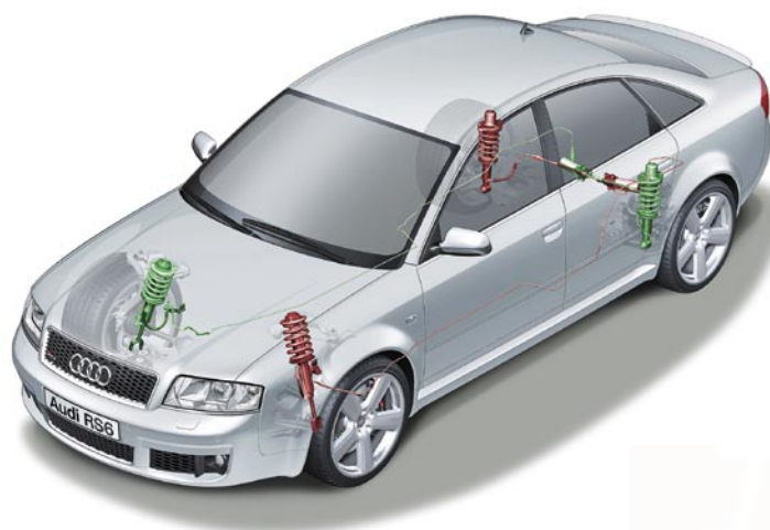
図1 相互連携ショックアブソーバシステム REAS(アウディ社名称 DRC)
