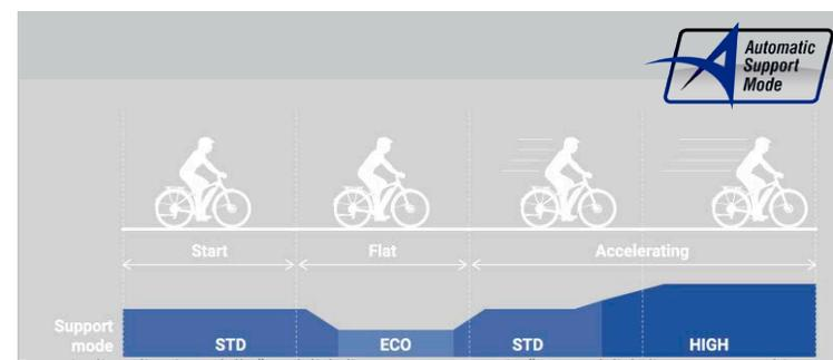
Esempio di applicazione della "modalità di supporto automatico". La modalità di supporto cambia automaticamente.
